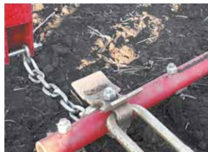
Регулировка угла атаки зуба
