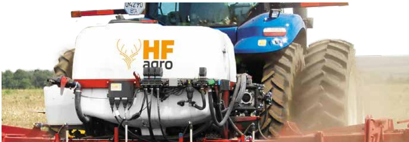
ШИЛЛИНГ можно оснастить дополнительным модулем HF Agro для внесения основных и стартовых жидких удобрений одновременно с основной работой агрегата.
