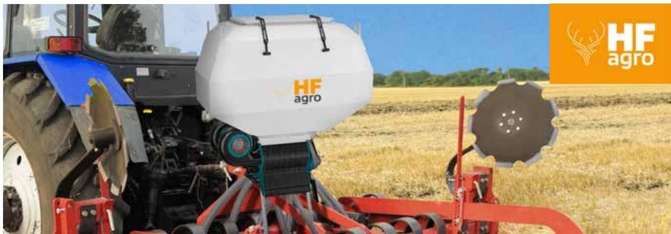
Дисковую борону ДУКАТ можно оснастить дополнительным модулем который позволяет вносить гранулированные удобрения, а так же использовать для подсева (например сидератов) за один проход с основной обработкой.
