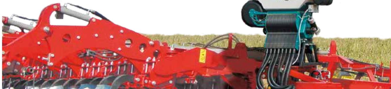
Тяжелую дисковую борону ДУКАТ GOLD можно оснастить дополнительным модулем который позволяет вносить гранулированные удобрения, а так же использовать для подсева (например сидератов) за один проход с основной обработкой.
