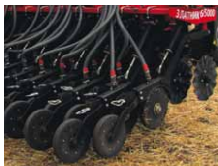
Двухдисковый сошник со смещением и волнистым диском
