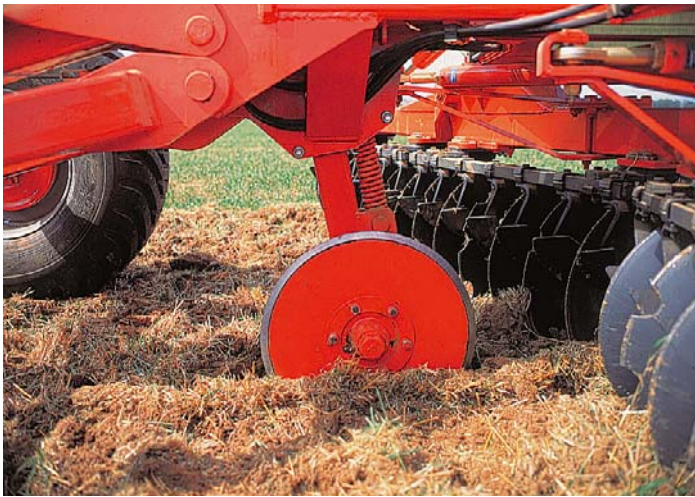
CRUMBLER ROLLER Ø 550 - 75 kg/m
