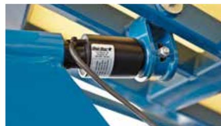
Три измерительных датчика DIGI-STAR® на каждый бункер
