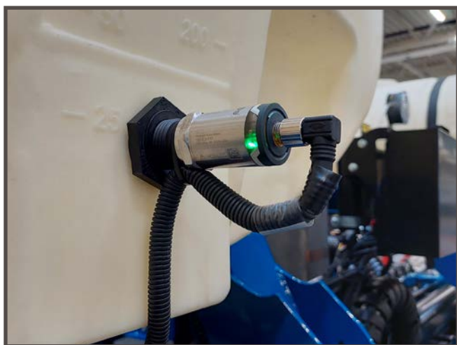
Датчик на баку для добрив
