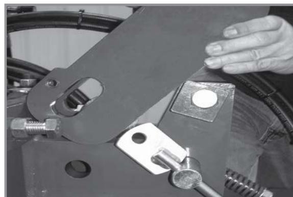
Зняття запобіжного крюка
