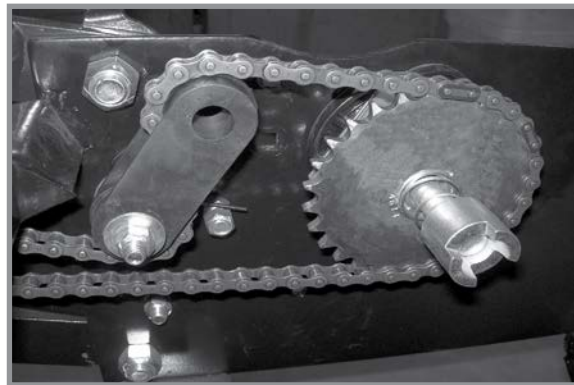
Привід вакуумного висівного апарату фронтальної висівної секції
