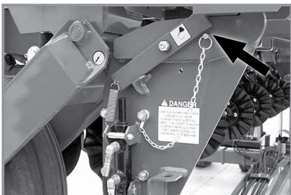
Стопорний штифт транспортувального фіксатора заблоковане транспортувальне положення
