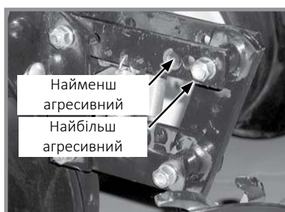
Регулювання кута нахилу коліс
