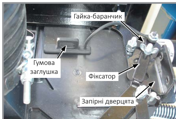
Розподільник системи центральних бункерів (вид з торця)
