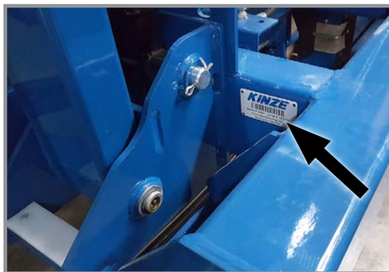
Розташування заводської таблички з серійним номером — зовнішнє праве Крило (2021 року випуску або новіші)
