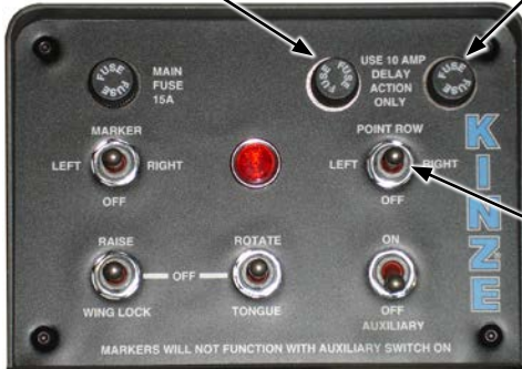
Однопозиційний блок управління муфтою відключення вказівного ряду
