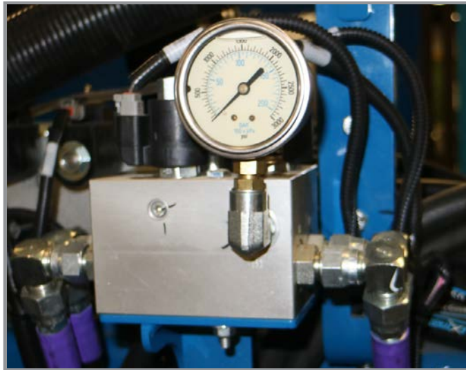
Манометр True Depth
