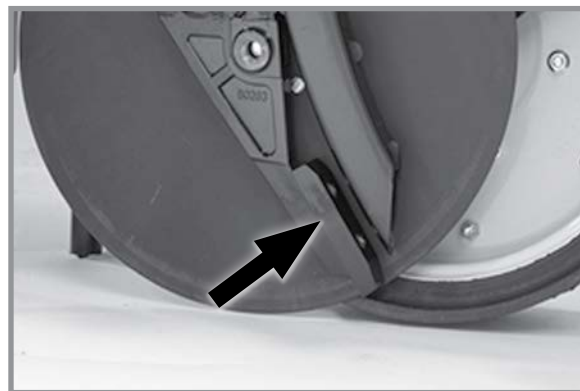
Захист насінняпроводу/внутрішній чистик (Копіююче колесо/дисковий ніж сошника для внесення насіння знятий)
