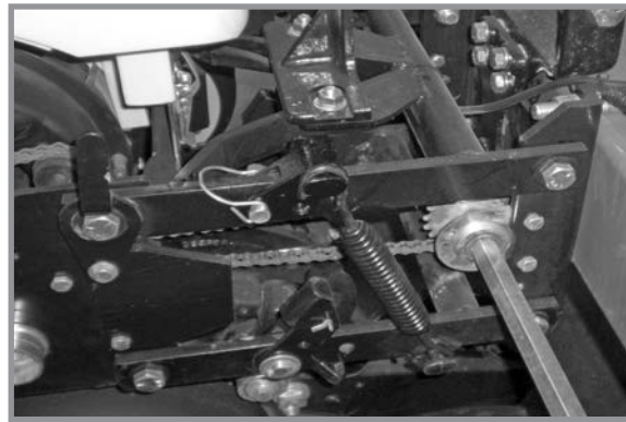
Допоміжні пружини фронтальної висівної секції
