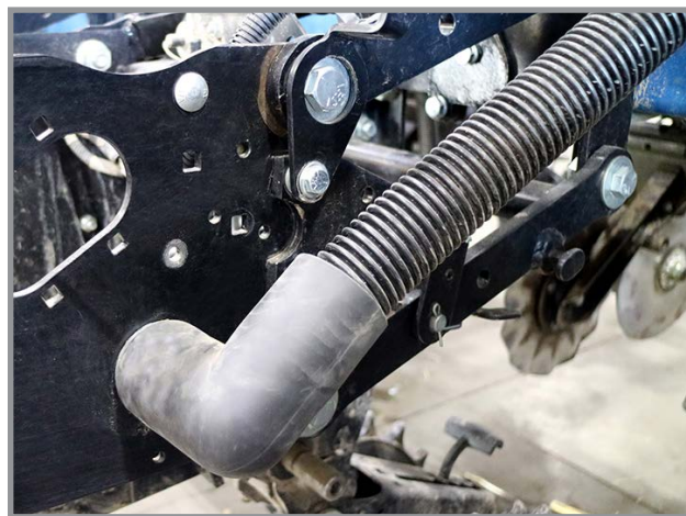
Відключення вакуумного шланга роздільного висіву
