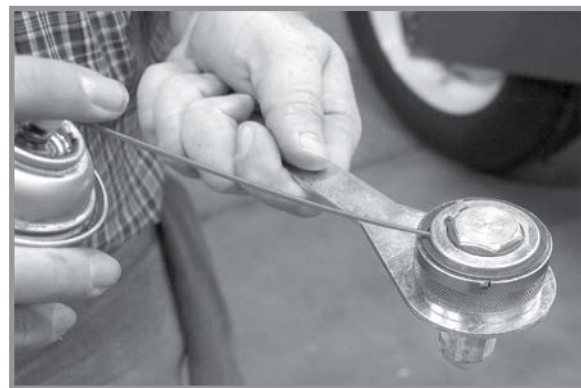
Мастило важеля з витою пружиною
