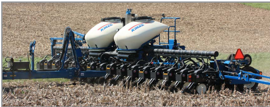
Сівалка на 16 міжрядь моделі 3605 з вакуумним висівним апаратом, роздільним висівом і системою центральних бункерів
