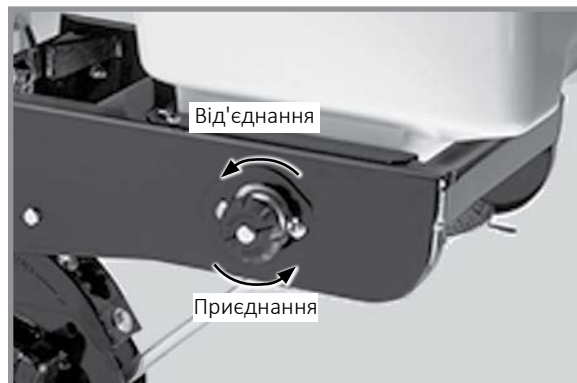
Ручка відключення подачі гранульованих хімікатів
