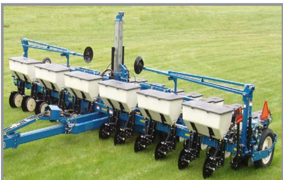
Встановлене додаткове обладнання для сухих добрив
