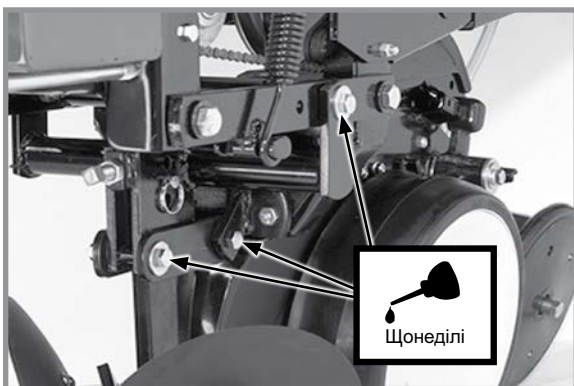
Паралельні навісні пристрої дискового борознороба з кріпленням на висівній секції (по 6 точок змащування на ряд)
