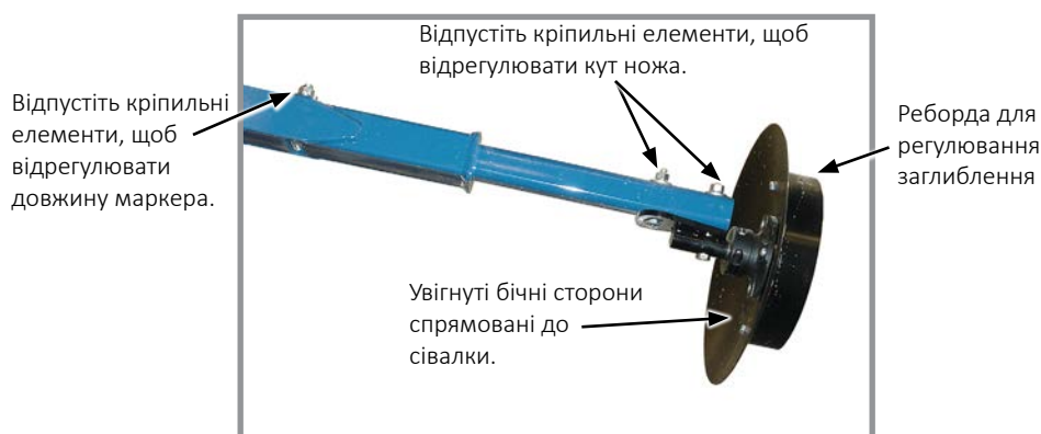
Регулювання кута дискового ножа маркера
