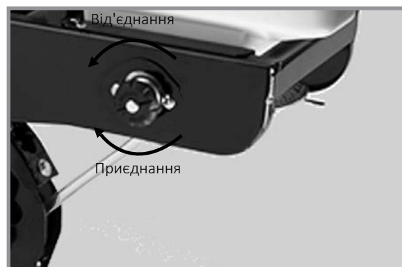
Розчіпний пристрій приводу для гранульованих хімікатів
