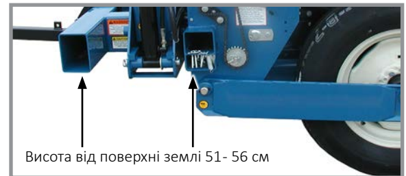
Вирівнювання рами сівалки
