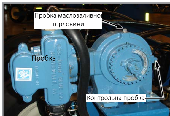
Розташування заливної та контрольної пробки поршневого насоса
