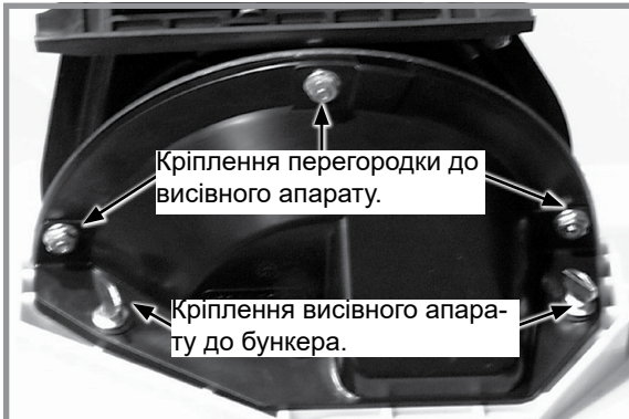
Зняття висівного апарату та перегородки
