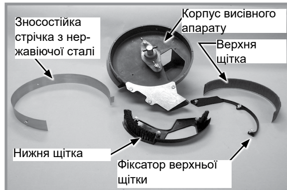
Деталі щіткового висівного апарату
