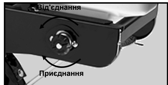
Розчіпний пристрій приводу для гранульованих хімікатів
