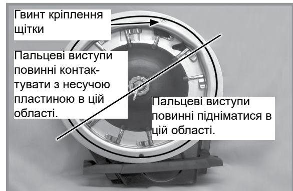
Правильна робота пальчикового висівного апарату
