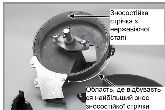
Зносостійка стрічка з нержавіючої сталі
