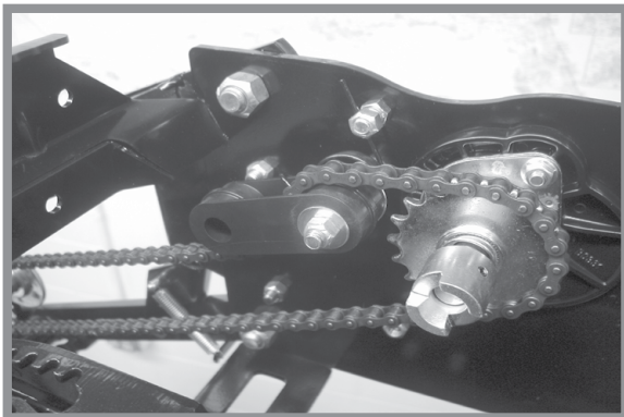
Привід механічного висівного апарату фронтальної висіваючої секції
