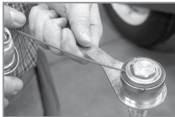
Змащування важеля з витою пружиною
