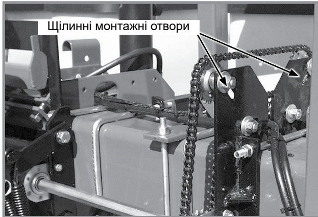
Регулювання натягу ланцюга приводу роздільного висіву
