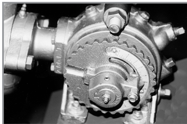
Поршневий насос для рідких добрив
