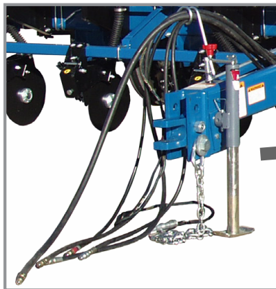
Встановлена підйомна опора
