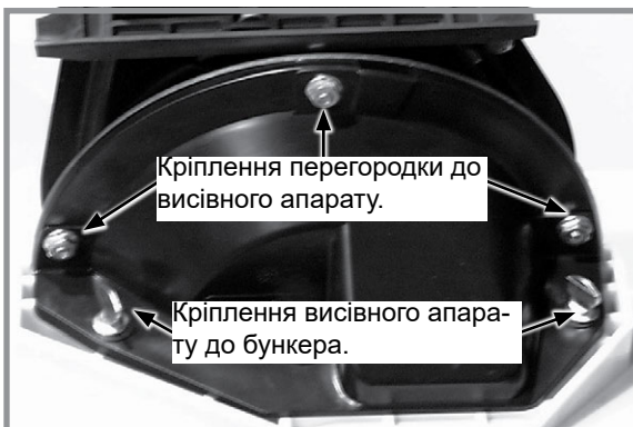
Зняття висівного апарату та перегородки
