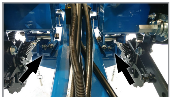
Розташування стопорних штифтів крил
