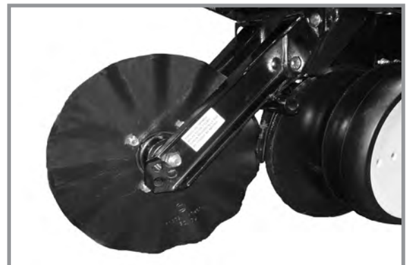
Дискові ножі для нульової обробки ґрунту з кріпленням на висівній секції
