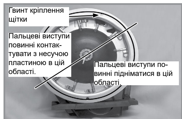
Правильна робота пальчикового висівного апарату
