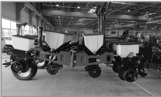
Встановлене додаткове обладнання для сухих добрив
