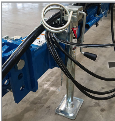
Встановлена підйомна опора
