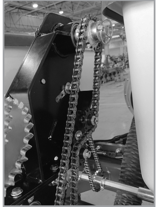
Трансмiсія приводу для внесення добрив
