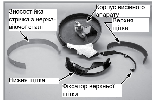
Деталі щіткового висівного апарату
