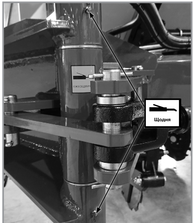
Шарнірні з'єднання крил - по 2 точки змащування на крило.
