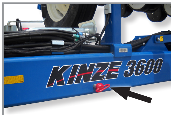
Предохранительный штифт дышла в положении для транспортировки
