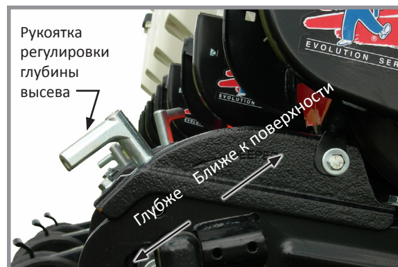
Регулировка глубины высева
