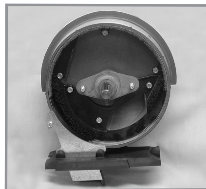
Показана сеялка без установленного диска для внесения семян
