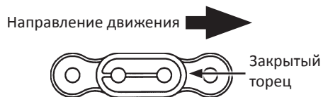
Привод вакуумного высевающего аппарата фронтальной высевающей секции
