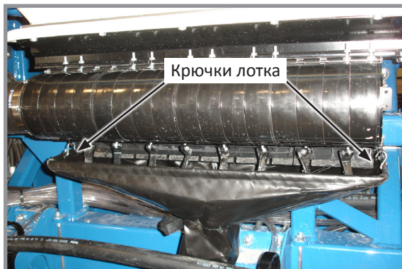
Установленный очистной лоток
