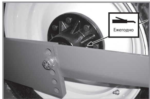
Подшипники транспортных колес — по 1 на ступицу
