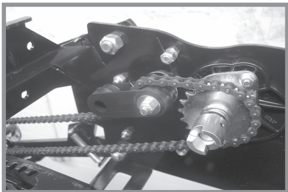
Привод механического высевающего аппарата фронтальной высевающей секции
