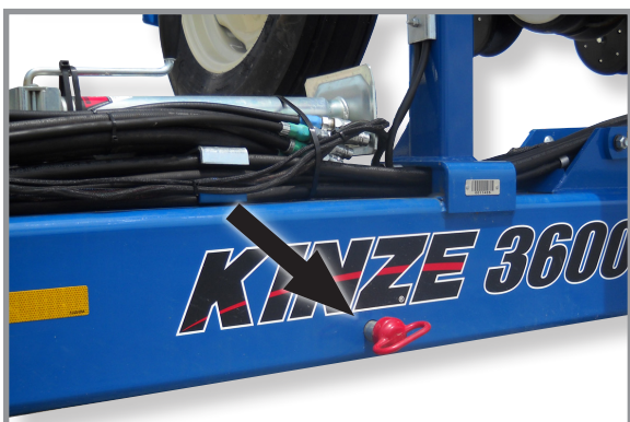
Предохранительный штифт дышла, установленный в положение для транспортировки
