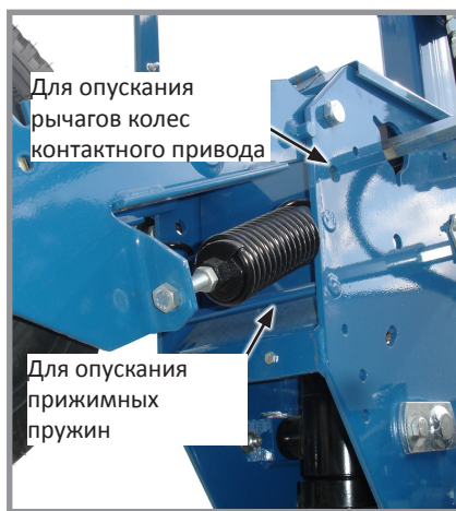
Регулировка колес контактного привода
