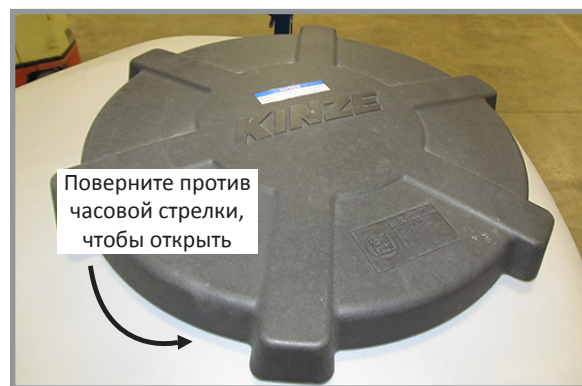
Крышка резервуара центрального бункера
