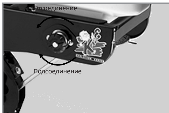
Отсоединение привода для внесения гранулированных химикатов
