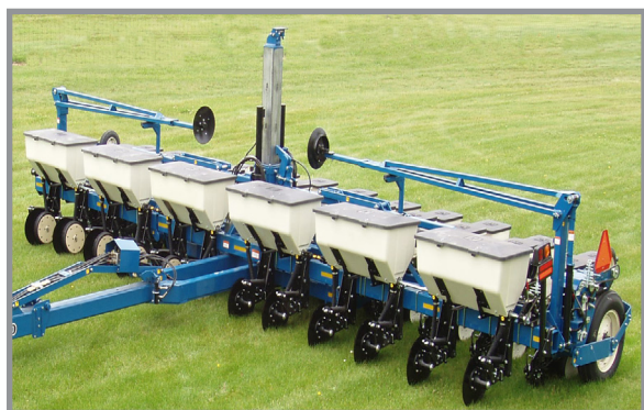
Установленное дополнительное оборудования для сухих удобрений
