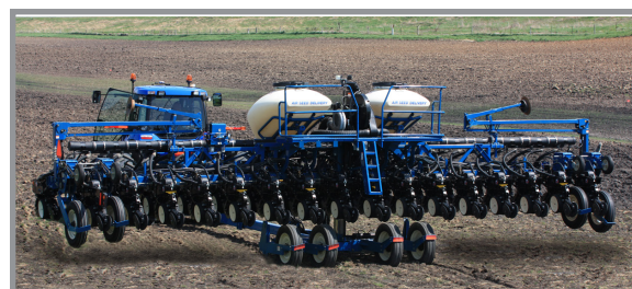
Поворот из транспортировочного положения в рабочее
