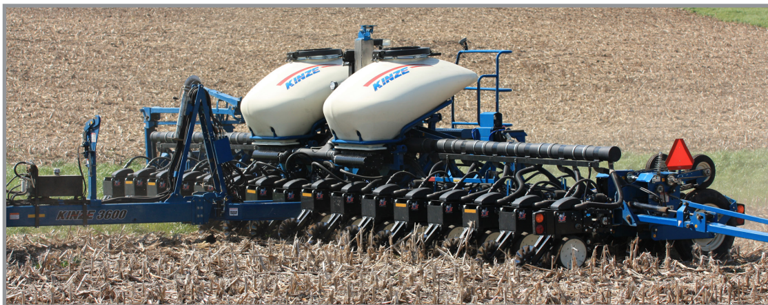
16-рядная сеялка, модель 3600, оснащенная вакуумным высевальным аппаратом, системой разделения рядов Interplant и системой центральных бункеров
