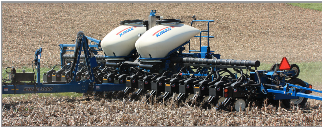
16-рядная сеялка модели 3600, оснащенная вакуумным высевальным аппаратом, системой разделения рядов и системой центральных бункеров
