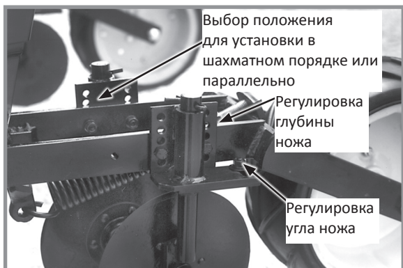
Регулировка заделывающих дисков
