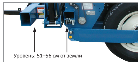
Выравнивание рам сеялки
