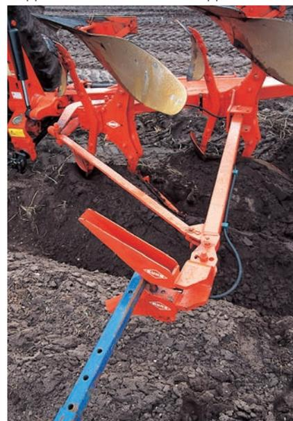
Доступный для всего спектра плугов, данный кронштейн позволяет проводить вспашку с прикатыванием (т.е. установить каток). На крючкообразной части кронштейна, где существует наибольший риск повреждения, все ниппели для смазки и гидравлические трубки защищены, поскольку находятся внутри конструкции. Кронштейн легко складывается в транспортное положение.
