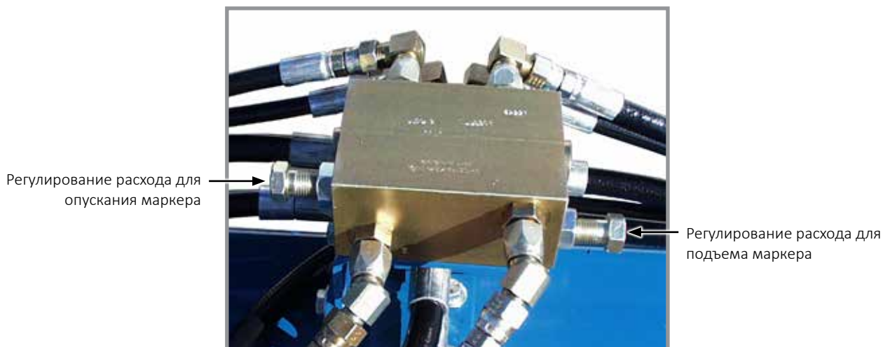
Клапаны регулировки расхода маркеров
