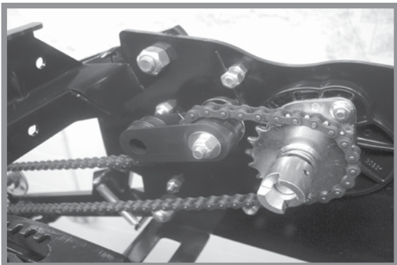
Привод механического высевающего аппарата фронтальной высевающей секции
