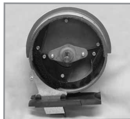
Показана сепалка без установленного диска для внесения семян
