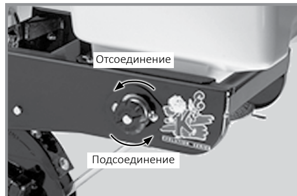
Выжимная рукоятка привода оборудования для гранулированных химикатов
