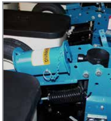
Установленное блокировочное устройство Блокировочное устройство в положении для хранения
