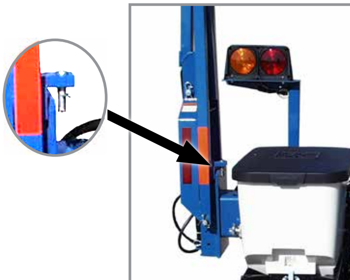
Расположение штифта блокировочного устройства на рычаге маркера
