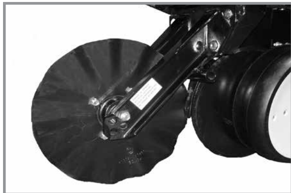
Дисковые ножи для нулевой обработки почвы, устанавливаемые на высевающие секции
