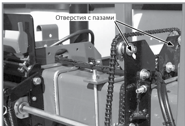
Регулировка натяжения цепи привода системы разделения рядов
