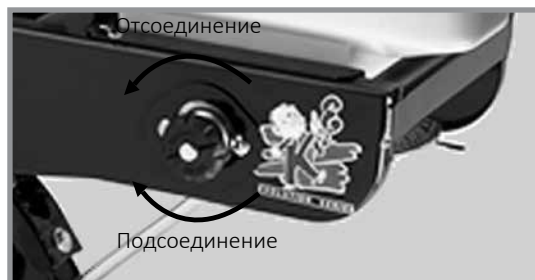
Отсоединение привода для внесения гранулированных химикатов
