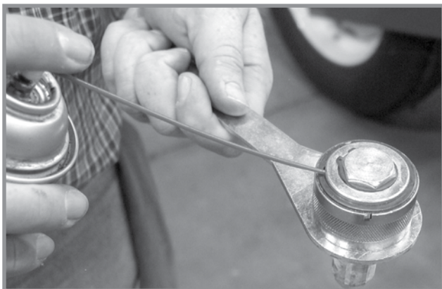
Смазка рычага с витой пружиной
