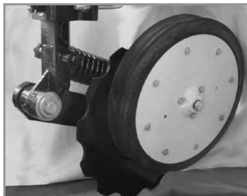
Регулятор заглубления/копирующее колесо зубчатого однодискового сошника
