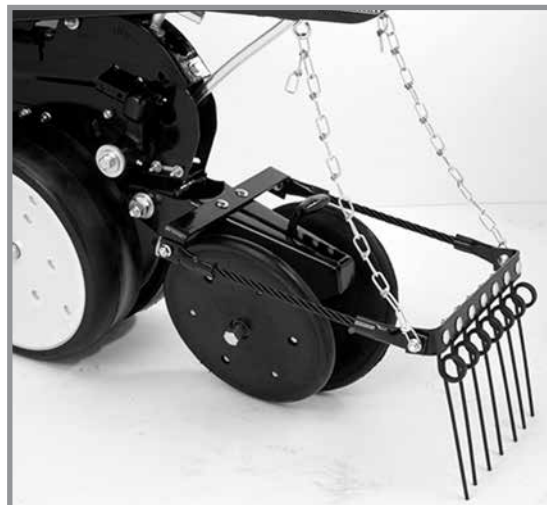
Устройство для внесения удобрений с пружинными зубьями
