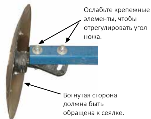
Регулировка угла дискового ножа маркера
