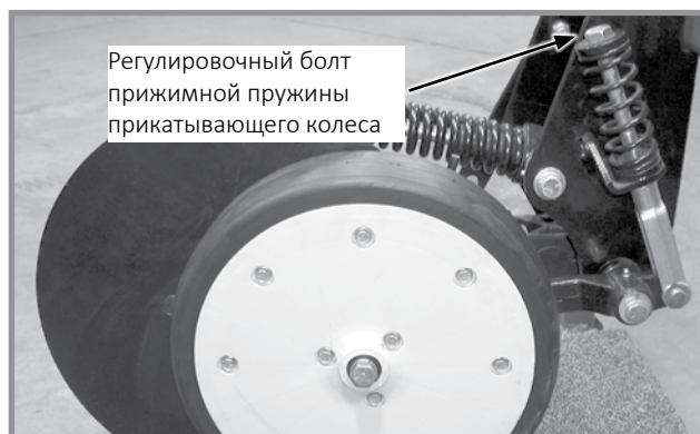
Регулировка прижима прикатывающего колеса
