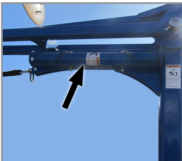
Блокувальний пристрій маркера в положенні для зберігання
