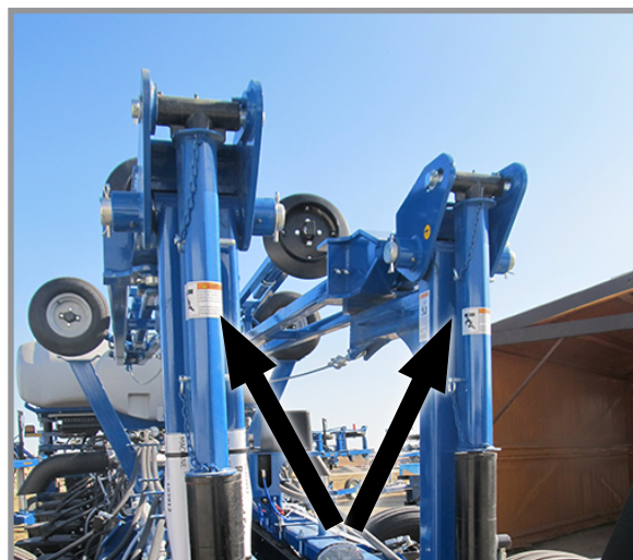
Встановлений блокувальний пристрій маркера
