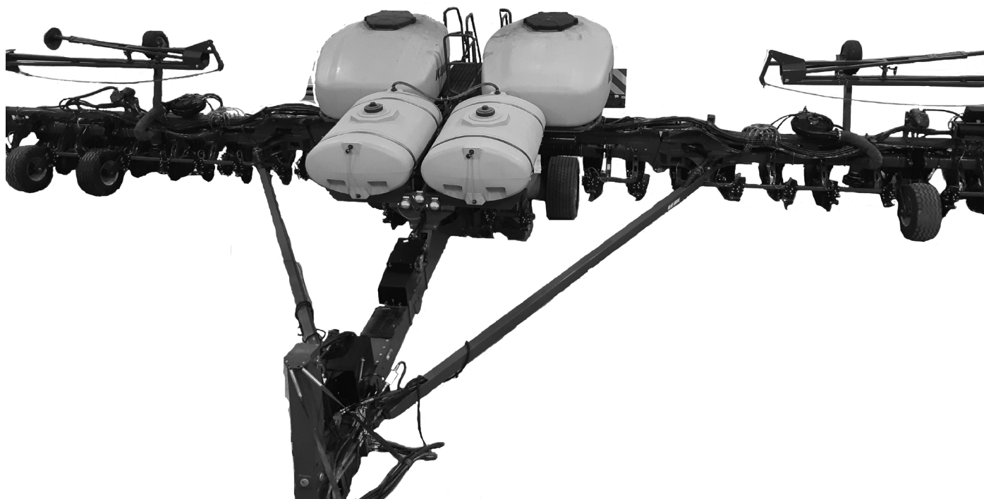
Обладнання для внесення рідких добрив встановлене на 4805 системі центральних бункерів
