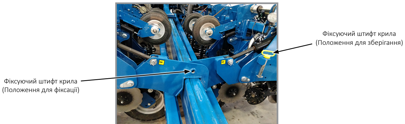
Від'єднання дишла від гаків крил
