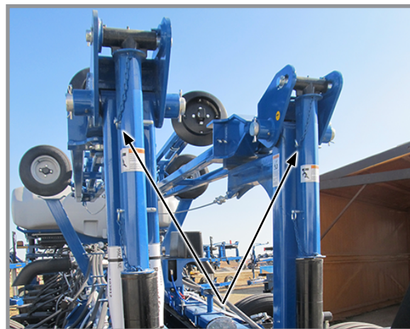
Встановлений блокувальний пристрій маркера
