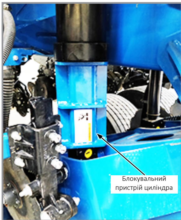
Встановлений блокувальний пристрій циліндра осі транспортних коліс
