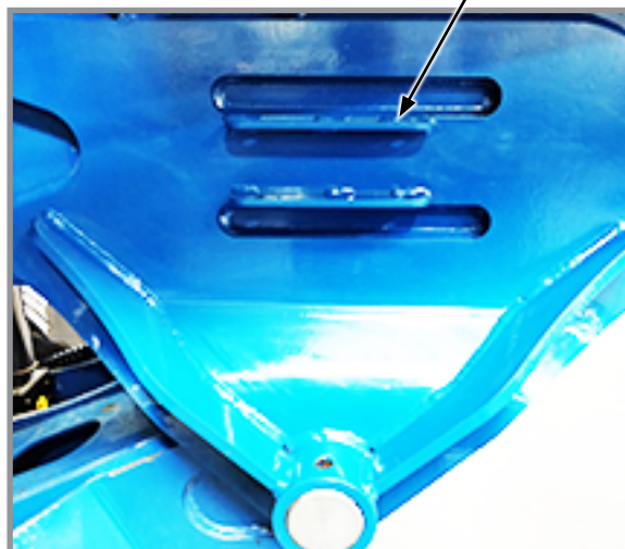
Кронштейн для зберігання блокувального пристрою циліндра
