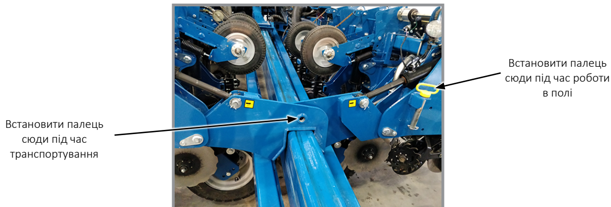
Від'єднання диска від гаків крил
