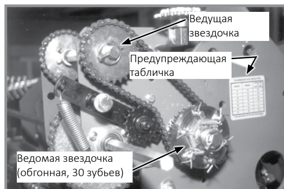
Ведомые звездочки двухскоростной муфты отключения указательного ряда
