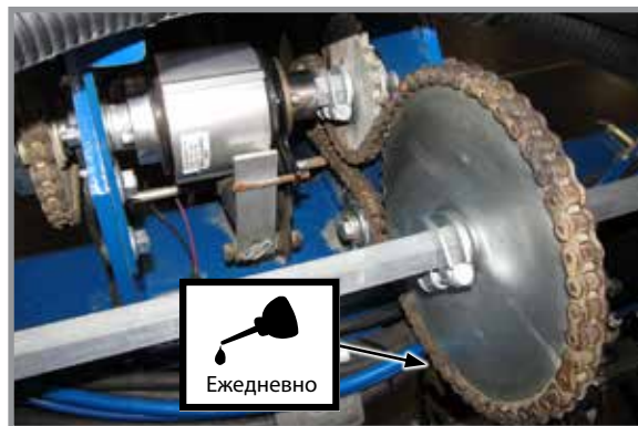
Цепи привода внутреннего модуля (муфта отключения указательного ряда)
