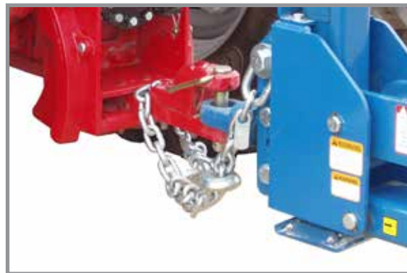
Присоединение предохранительной цепи к трактору
